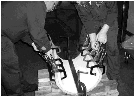
Obrázek č. 7: Upevnění SXL ke kovovému tělesu svorkami, použit mírný přtlak.
